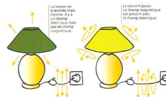
Exemple de champ électrique et champ magnétique (Source : tenormelec.com)
