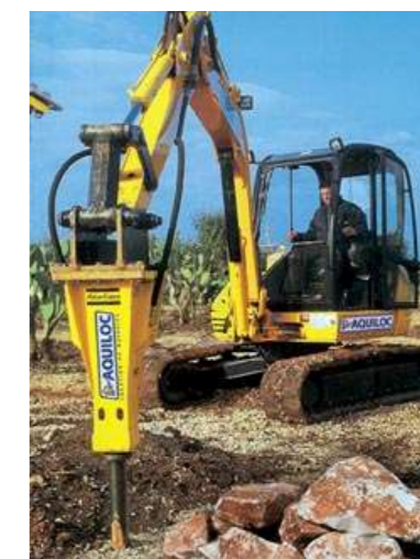
Brise-roches hydraulique (Source : Aquiloc)
