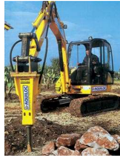
Brise-roches hydraulique (Source : Aquiloc)
