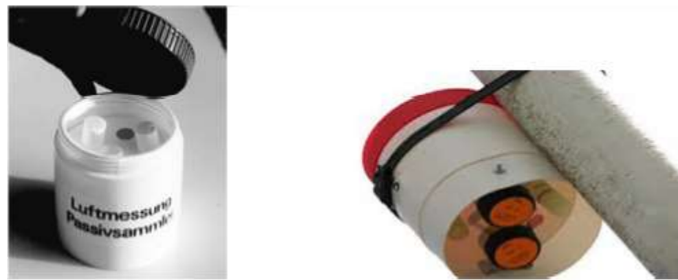
Dispositif de mesure pour la qualité de l'air in-situ
