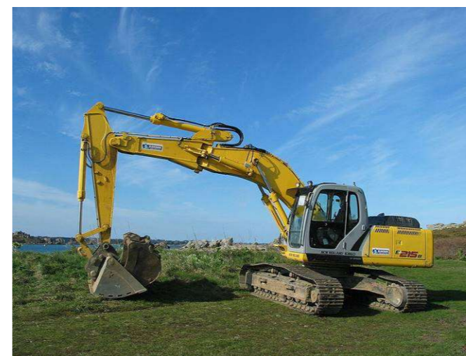
Pelle mécanique hydraulique ( https://commons.wikimedia.org/w/index.php?curid=3875087 )
