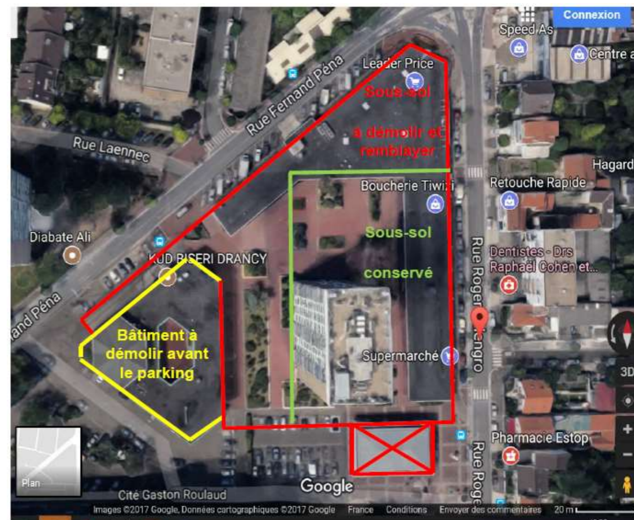
Zones démolies au niveau du parking (projet) (étude de résidentialisation)
