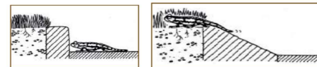
Un exemple de dispositif évitant de piéger la petite faune le long des bordures hautes.
