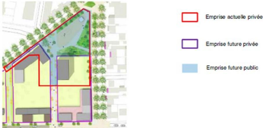
La rampe d'accès actuelle ainsi que la partie ouest du parking devront être démolies pour permettre la réalisation d'un programme immobilier et d'une rue traversante. L'ensemble de l'étanchéité ainsi que la redistribution des issues de secours et gaines de ventilation devront être reprises dans le cadre de l'aménagement de la place publique, rendu possible par la démolition de la galette commerciale.
